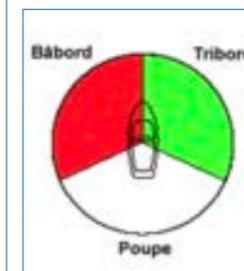
**Tribord** est le côté droit d'un bateau lorsqu'on regarde vers l'avant (la proue). Le feu à tribord pour naviguer la nuit et par visibilité réduite est de couleur **verte**.
